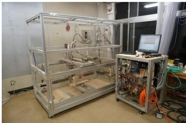
図 2 五軸加工機械 (左) とコントローラユニット (右)
