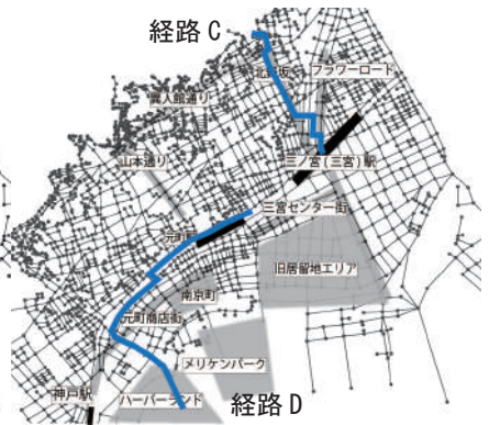
図10 最小代謝的換算距離の経路抽出
