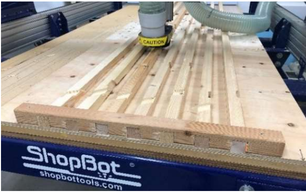
図3 CNCマシンでのモックアップ製作
