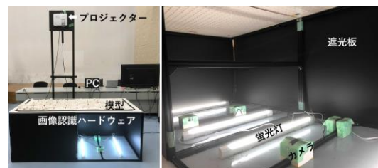
図 2. システムの外観及び画像認識ハードウェア
