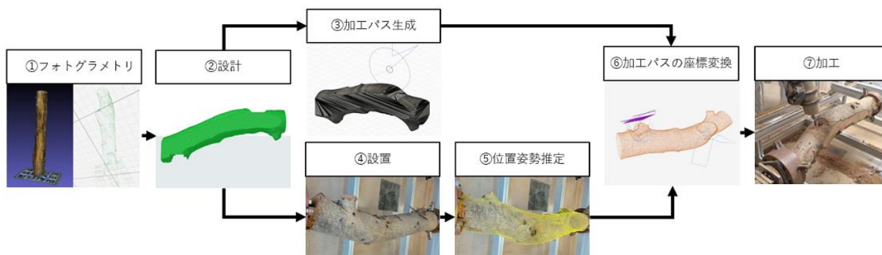
図 1 位置推定システムを用いた丸太材加工のワークフロー
