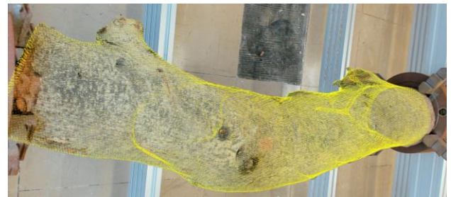
図 10 カメラから撮影した画像に推定位置の丸太材を投影した画像
