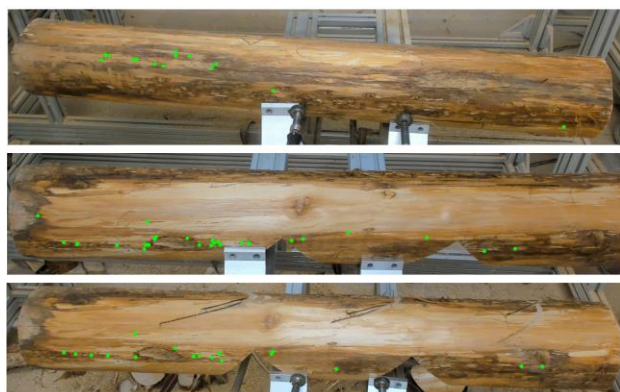
図 14 置き直した丸太材の特徴点マッチングできた点を示した画像(上から置き直し一回目、二回目、三回目)
