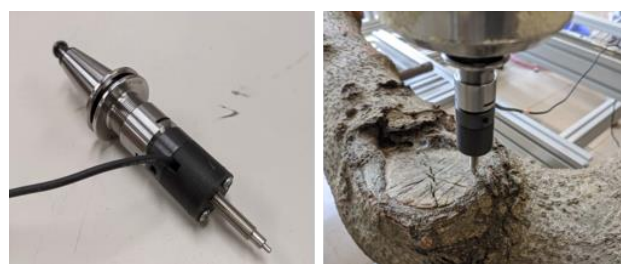
図5 ATC モーターで取り付けられる用になったタッチセンサ(左)、タッチセンサによる表面の計測(右)
