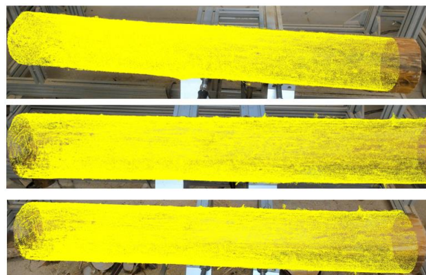
図 15 置き直した丸太材の推定位置を示した画像(上から置き直し一回目、二回目、三回目)
