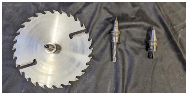
図3 実験で使用した加工ツール、丸ノコ(左)、スパイラルビット(中)、アリ溝カッター(右)
