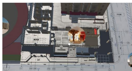
図2 設計図書と建物モデルの重畳による情報の相互補完
