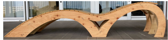
写真5 kerf bending の浮きの様子
