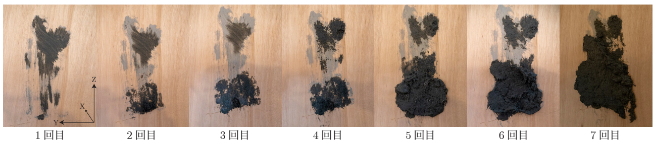
図3 ロボットアームによる土塗り実験(実験1)後の壁土の状態
