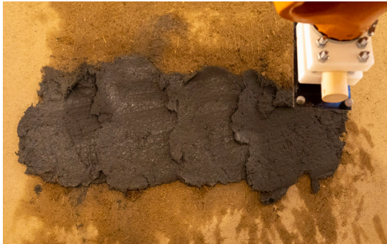
図10 4回連続で行った土塗り後の壁土の状態
