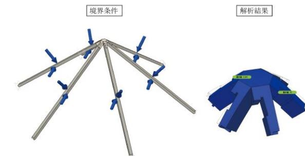
図9 接合部の静的応力解析
