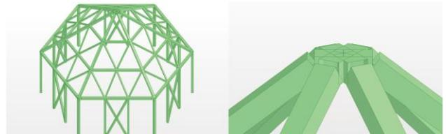
図4 試設計モデル(左:全体 右:かぶら東型接合部)
