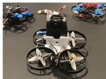
360°パノラマカメラを搭載したドローンをOsaka Metroの ホーム天井裏に侵入させ、内部をビデオ撮影 (画像：アイ・ロボティクス)
