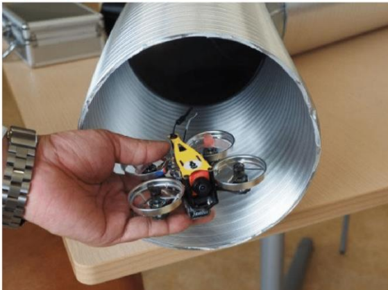
内径20cmのダクトと超小型ドローン (写真：家入龍太)
