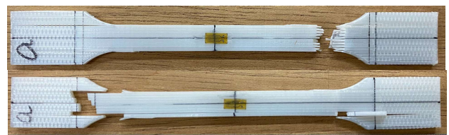
図14 試験後の試験片(上:垂直積層 下:斜め積層)
