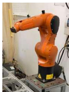
図 3 六軸積層方式
