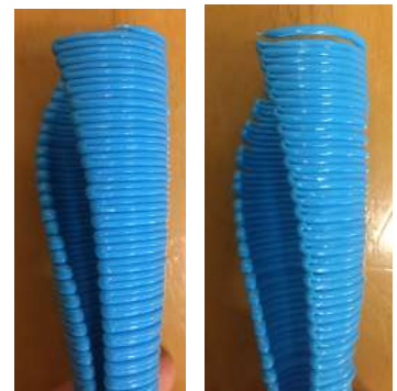
図 9,10 エッジの射出量制御
