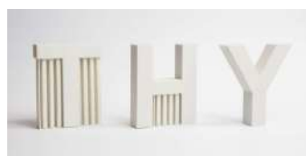
図 2 サポート材でのプリント
