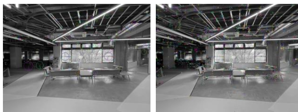
図 1 SIFT (左) と SuperPoint (右) による局所特徴量
