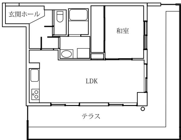
Figure 1. 本報の事例となる住空間の平面図。1LDKで2方向にテラスが隣接している。内部空間面積は壁芯52.3㎡。
