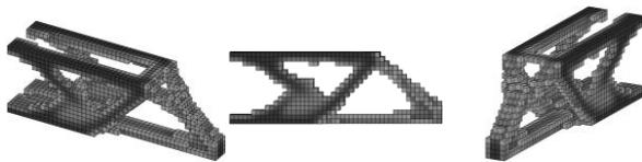
図 16 : 最適性規準法による解 (48 × 16 × 12)
