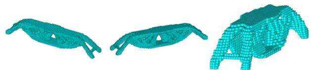
図 11 : SVR を用いた最適化結果 ( $96 \times 16 \times 16$ )
