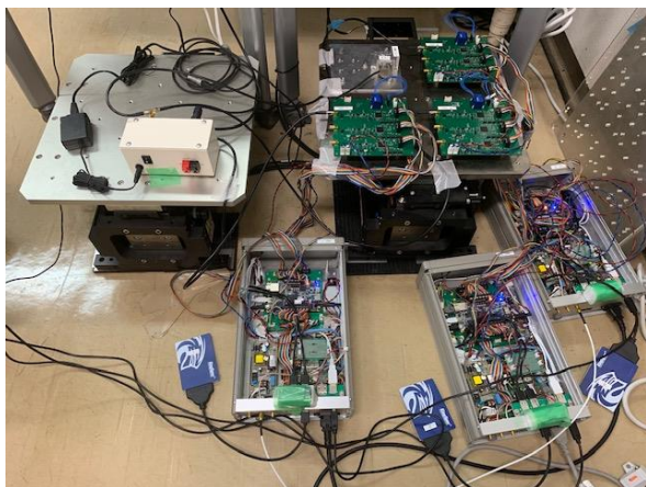
図4 開発したセンサモジュールと振動試験装置
