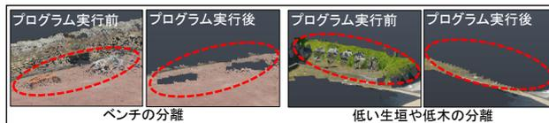
図7 点群分離結果の例(分離可)
