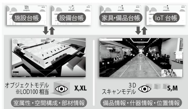
図 6：3D モデルと 3D スキャンデータのハイブリッド構造
