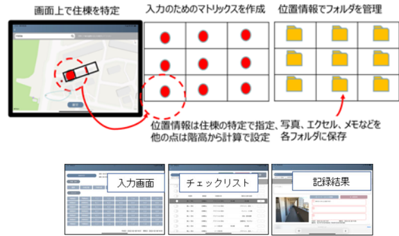
図5 タブレット端末用の点検アプリのイメージ
