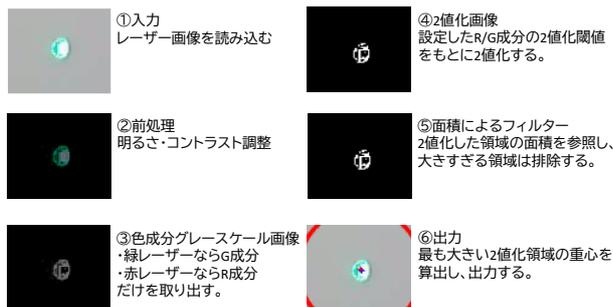
図 6 当初のレーザー検出処理
