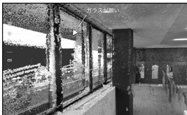
図6 点群による透光材の再現（ガラス）
