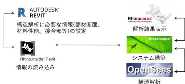
図4: Rhino.inside.Revitを用いたRevitとOpenSees for Grasshopperの連携フロー
