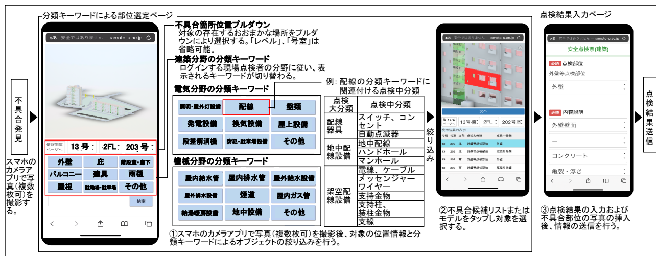
図2 分類キーワードによる部位選定の流れ
