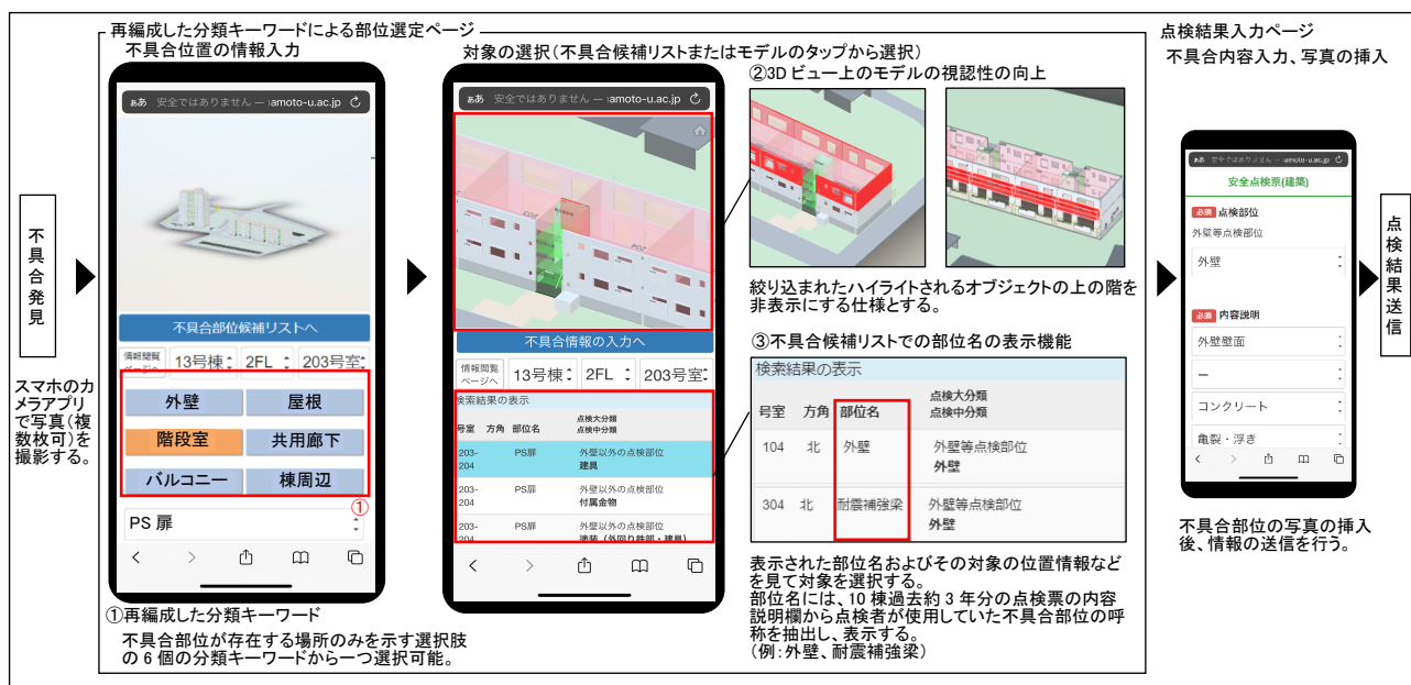
図3 改良した住棟点検支援システムの操作手順
