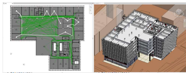
図 3 本部棟の BIM モデルとグラフ構造の地図
