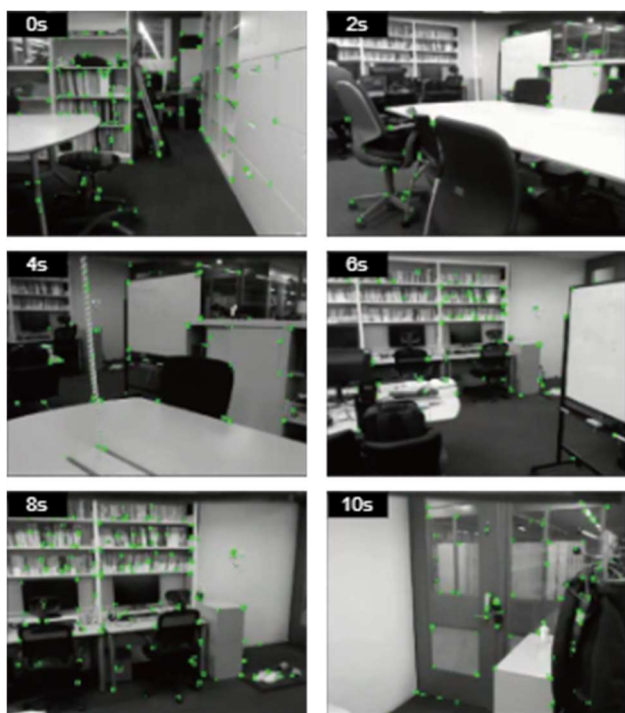
図 12 ドローンのカメラ映像と特徴点
